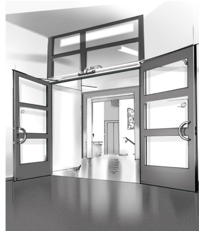
Beispielhafter Aufbau einer Brandschutztür mit Feststellanlage.
