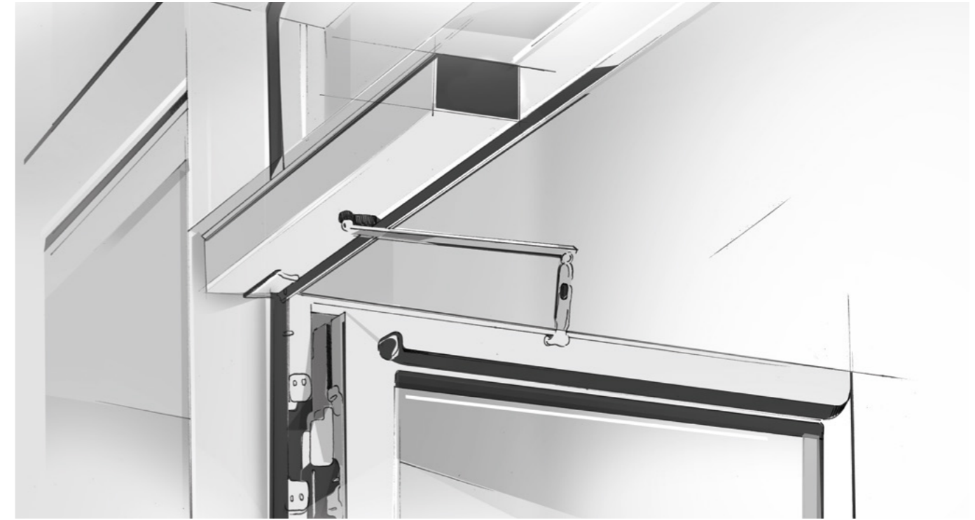
Beispielhafter elektromotorischer Antrieb mit Sensorleisten.
